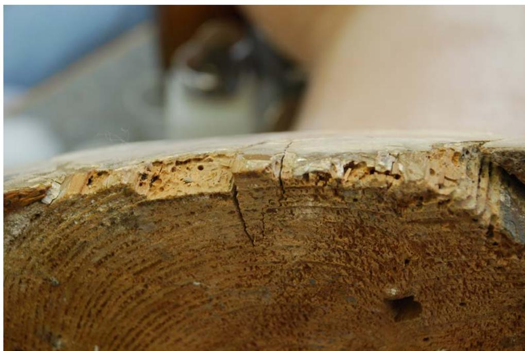
Figura 4- Orificios de salida y galerías de anóbidos
