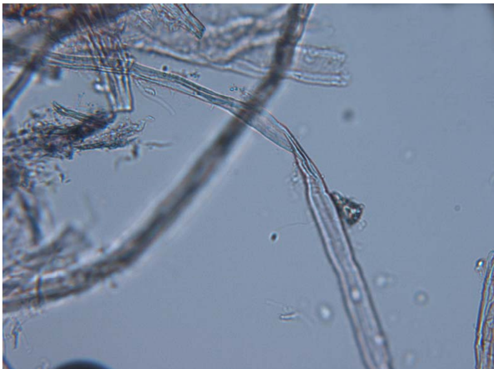
Figura 21. Fibra papelera de algodón, microscopio óptico con luz polarizada, 200X.
