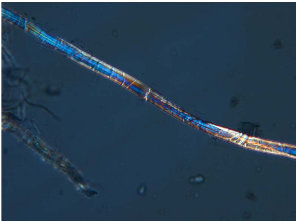
Figura 14. Fibra papelera de lino o cáñamo, microscopio óptico con luz polarizada, 200X.
