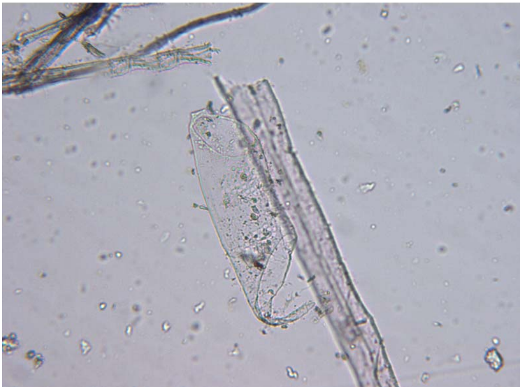
Figura 3. Fibras madereras de frondosas, vaso de álamo: punteaduras de los campos de cruce. Microscopio óptico con luz transmitida, 100X.
