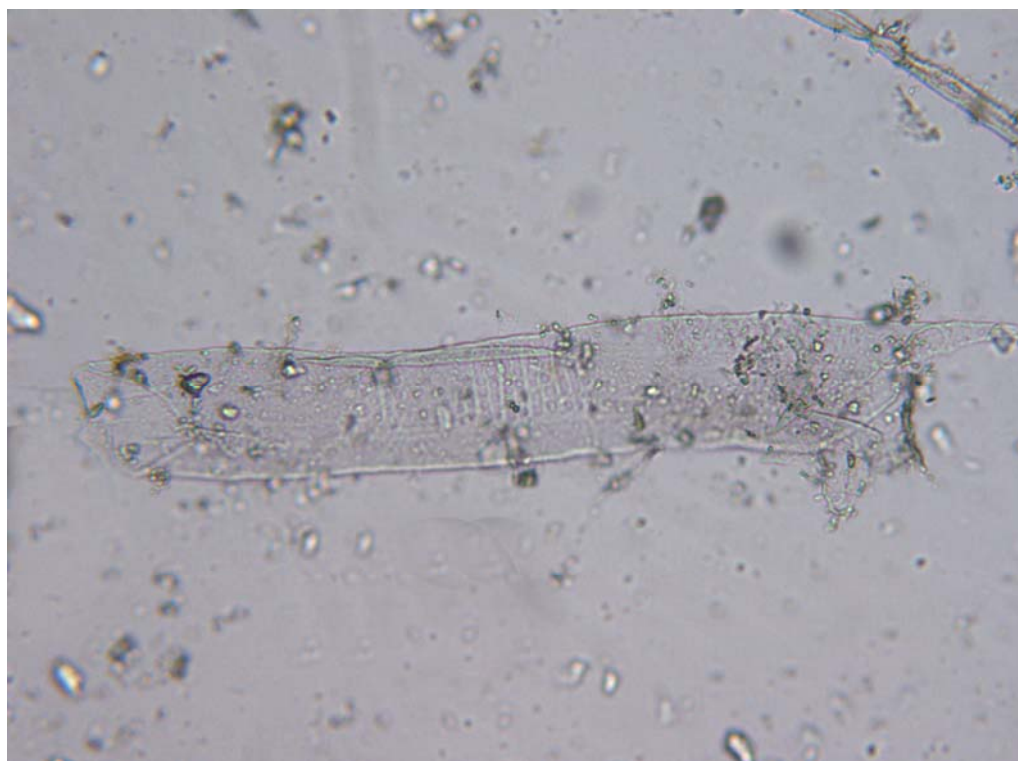
Figura 4. Fibras madereras de frondosas, vaso de álamo: punteaduras de los campos de cruce. Microscopio óptico con luz transmitida, 100X.
