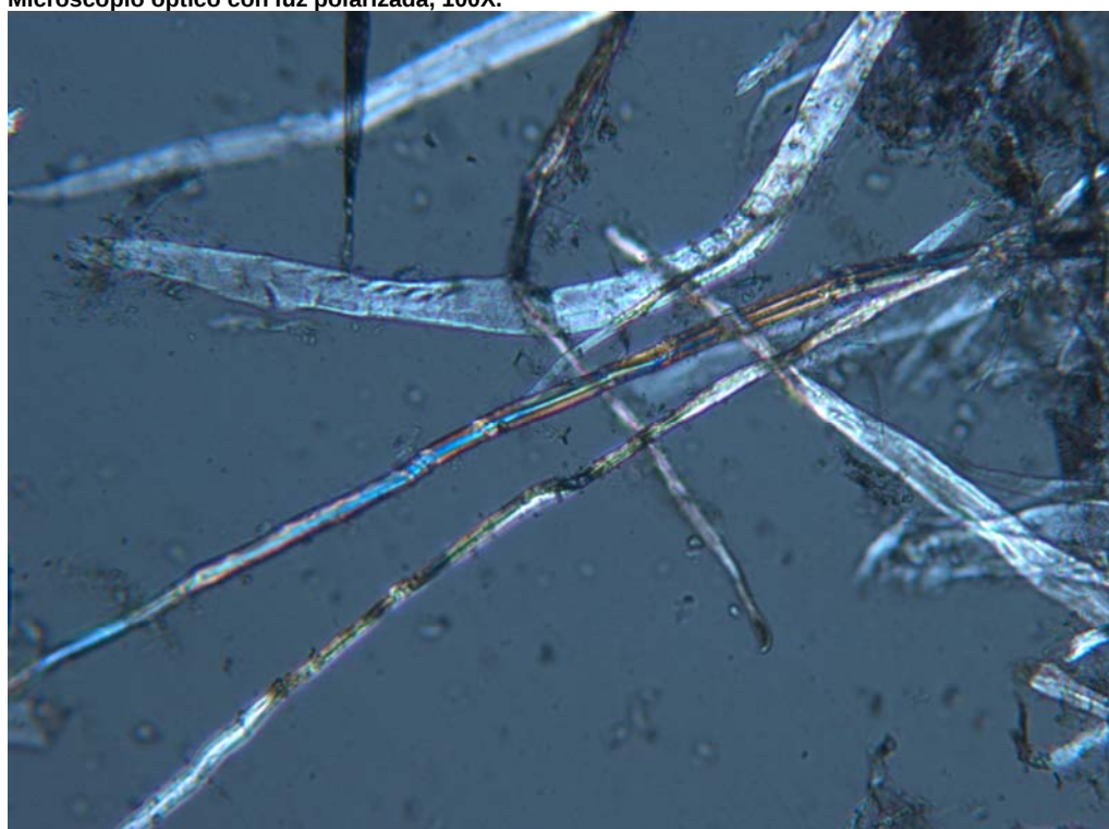
Figura 7. Fibras papeleras de lino o cáñamo y fibras madereras, microscopio óptico con luz polarizada, 100X.
