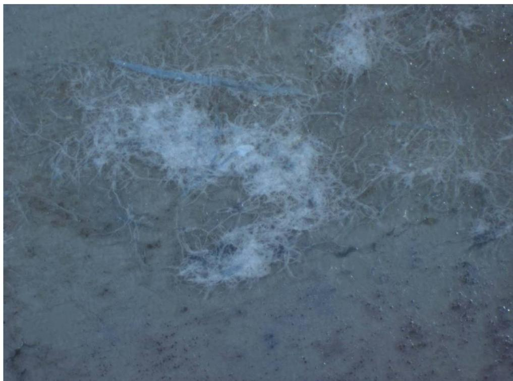
Fig. 12- Alteración microbiológica sobre negativo, observación al estereomicroscopio, 6X
