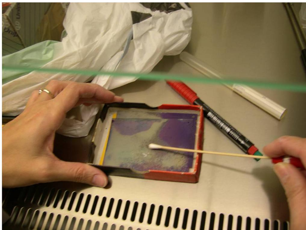
Fig. 15- Toma de muestras de microorganismos mediante hisopo estéril.
