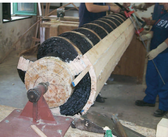
PROCESO DE CONSTRUCCIÓN DE UN TORNILLO DE ARQUÍMEDES EN LA ESCUELA TALLER FUNDACIÓN RIOTINTO
