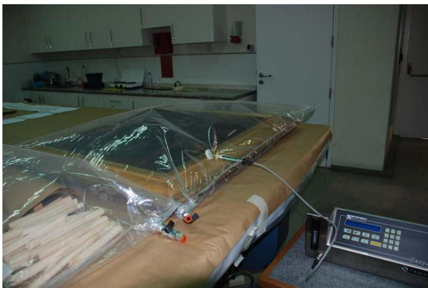
Figura 15. Tratamiento no tóxico de desinsectación mediante gases inertes (Ar).
