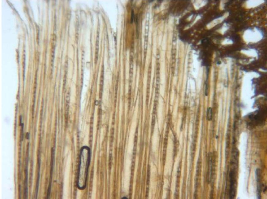
Figura 2. Muestra VNRS.m-01. Sección longitudinal tangencial, 50X. Microscopio óptico, luz transmitida.
