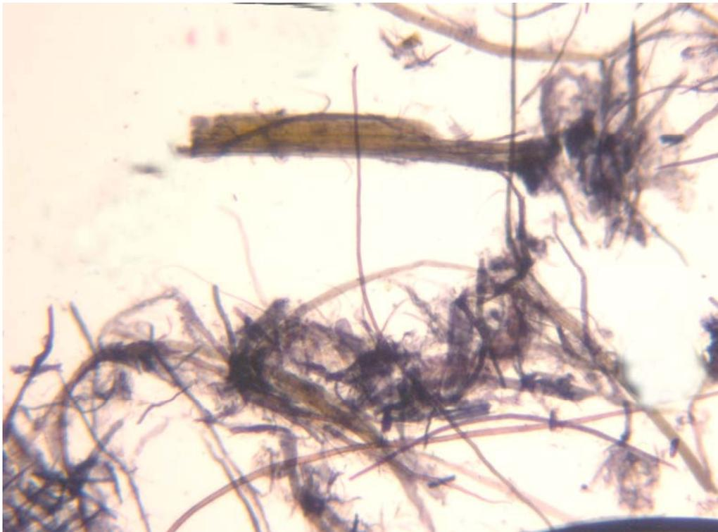
Figura 1. Fibras papeleras de color gris-azulado, teñidas con colorante de Herzberg, 50X.
