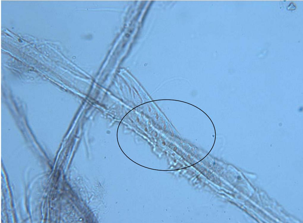
**Figura 6. Fibras madereras de conífera, punteaduras de los campos de cruce de tipo pinoide, microscopio óptico con luz normal, 100X.**
