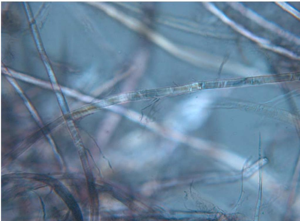
**Figura 3. Fibras papeleras de cáñamo y lino, microscopio óptico con luz polarizada, 200X.**
