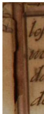
ACCIÓN CORROSIVA DE LAS TINTAS METALOÁCIDAS.
