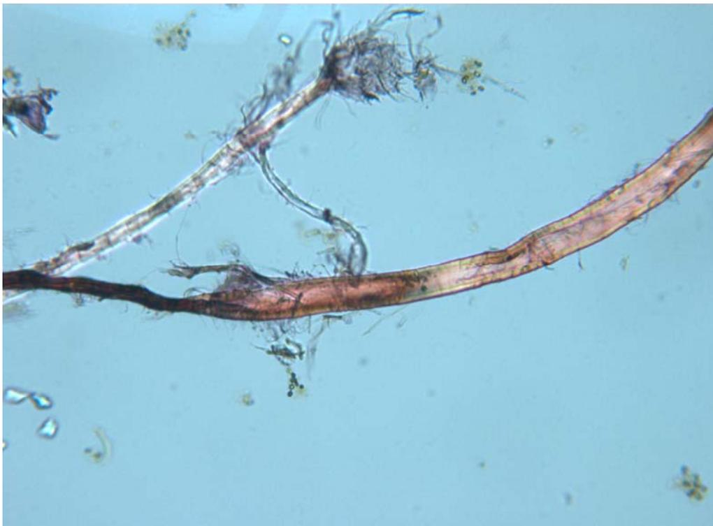
Figura 15. Fibra papelera de algodón, microscopio óptico con luz polarizada, 100X.
