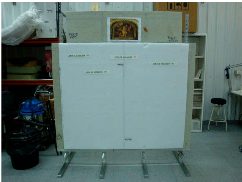
Capa de espuma de polietileno de media densidad que cubre la superficie del soporte ligero
