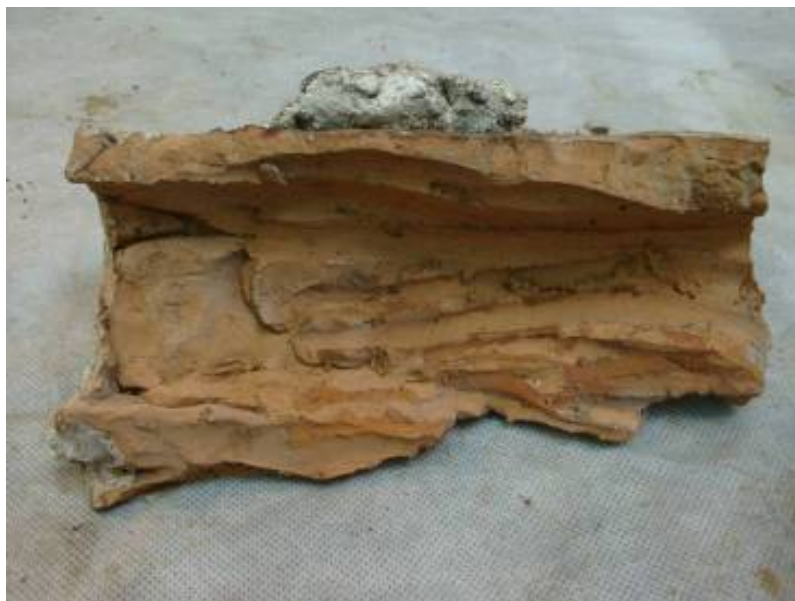
Marcas de dedos del trabajo interno de las piezas.
