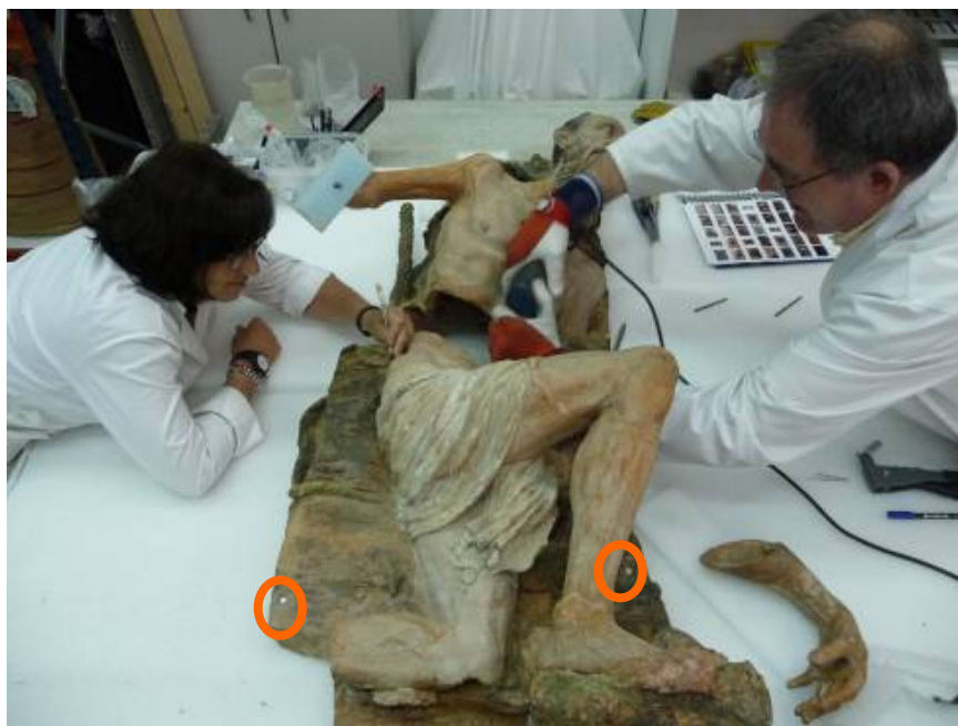
○ Puntos de anclaje de las placas por los agujeros originales.
