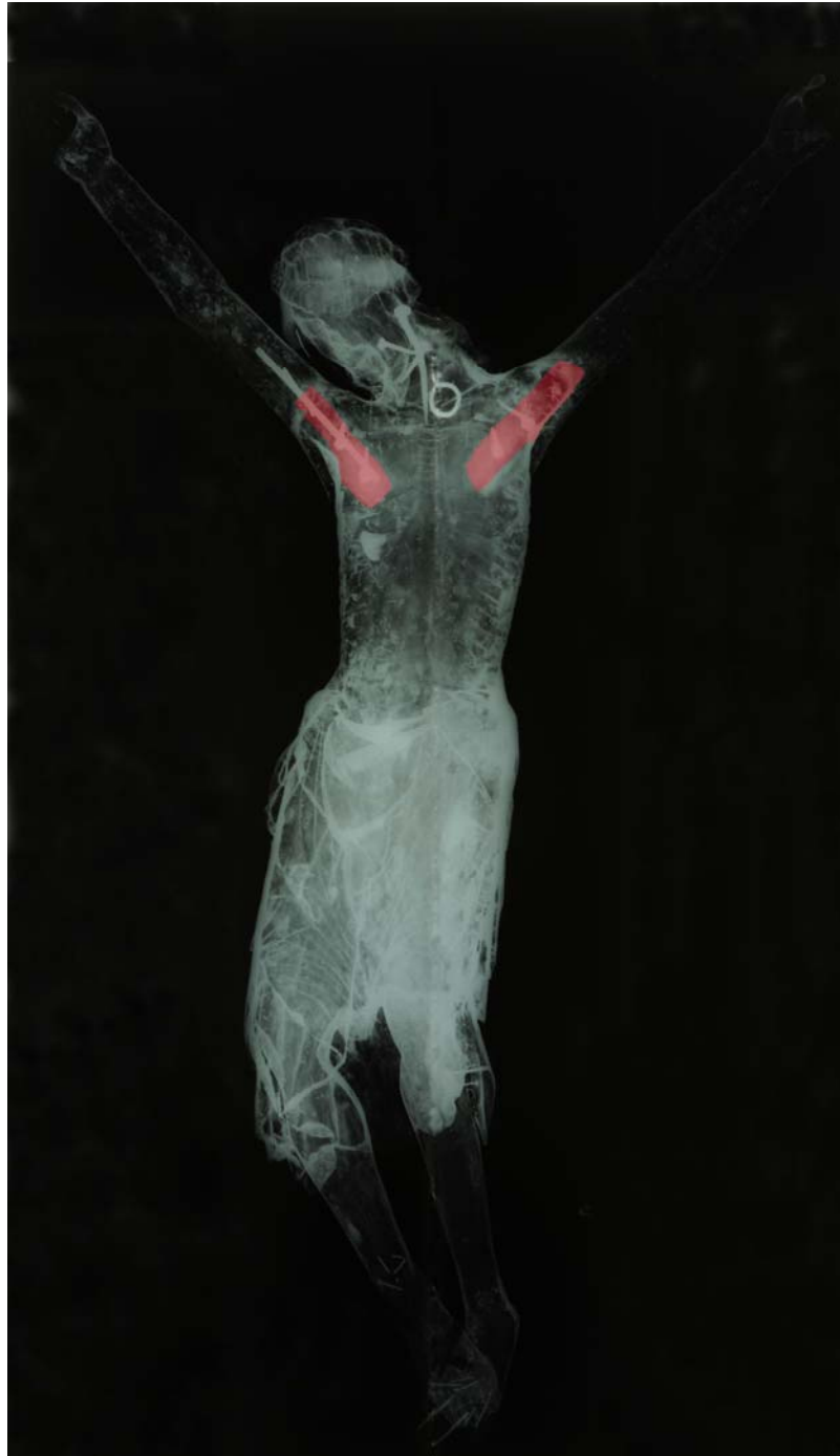
Estudio radiográfico con indicación de espigas de madera.
