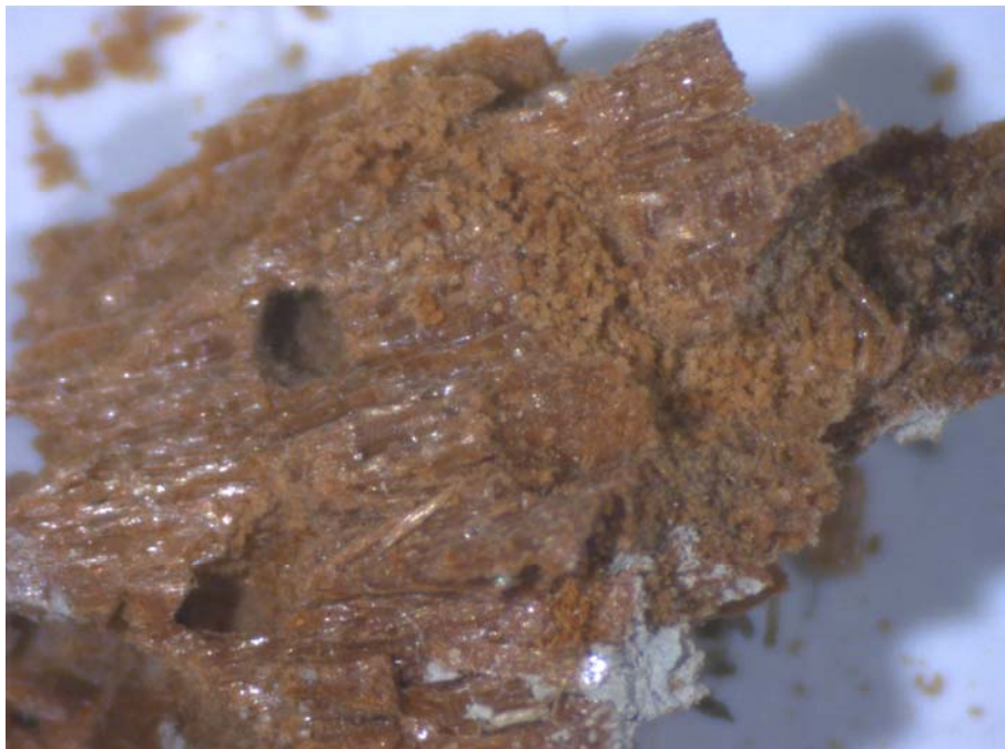
Orificio de salida de xilófagos anóbidos, 10X.
