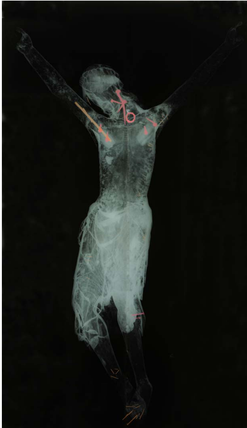
Estudio radiográfico con indicación de los elementos metálicos.
