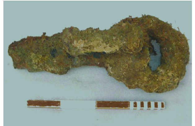
Lam. 1. Cabilla de hierro recubierta de concreción deformante de envoltura mineral y productos de colonización biológica. (Foto CAS)
