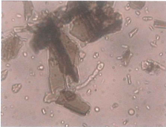
Fig. 13- RLC.15. Hifas y esporas de hongo superficial no causante de la pudrición de la madera, sección radial, 500X.
