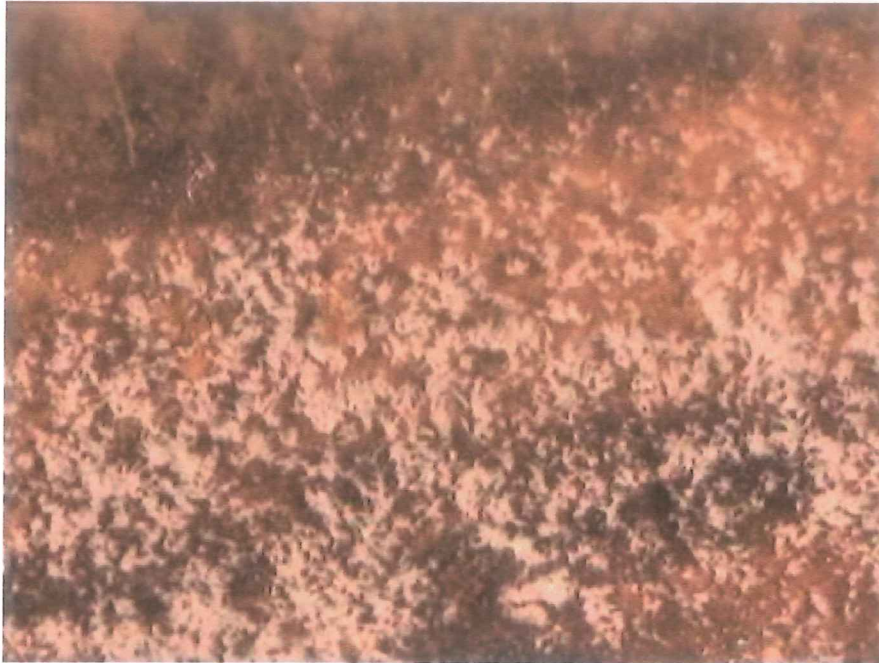
Fig. 18. RLC.19. Colonia de Penicillium sp. desarrollada en la superficie de la muestra de madera (sometida a H.R. elevada), 20X
