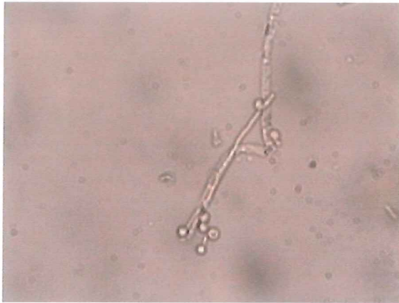
Fig. 12- RLC.15. Hifas y esporas de hongo superficial no causante de la pudrición de la madera, sección radial, 500X.
