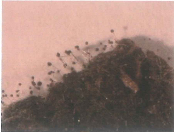
Fig. 22. RLC.20. Colonia de Aspergillus niger desarrollada en la superficie de la muestra de madera (sometida a H.R. elevada), 10X
