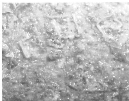
Figura 7. Imagen en la que se observa el objeto de cobre cubierto por sales producto de la oxidación del cobre.
