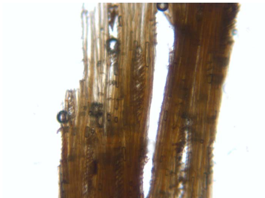
Figura 14. Muestra PGP.m-03. Sección longitudinal tangencial, 50X. Microscopio óptico, luz transmitida.
