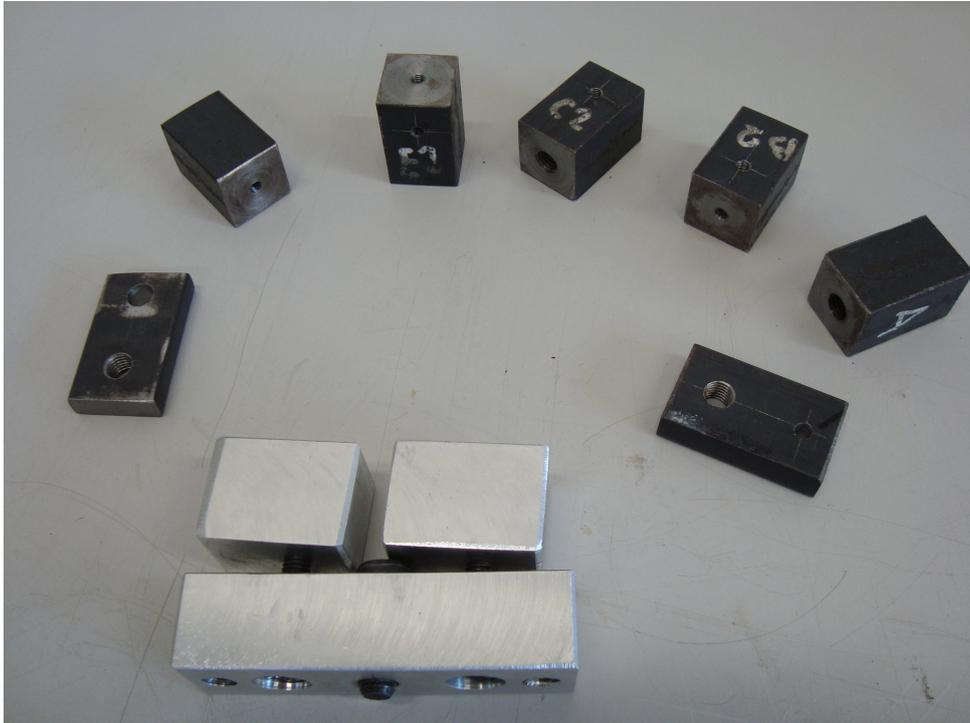
Figura 4: Útiles fabricados para la fijación de sensores a la estructura del paso
