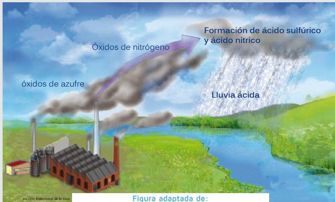
Los materiales pétreos calcáreos (calizas, mármoles, areniscas, calcáreas, etc.) son especialmente sensibles. La lluvia ácida ataca al carbonato cálcico, transformándolo en yeso y costra muy soluble que se desprende fácilmente.
