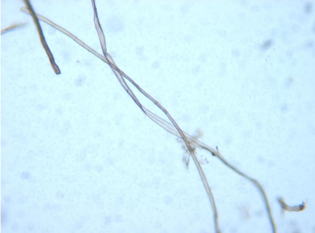
Figura 7. Fibras papeleras de algodón, microscopio óptico con luz blanca, 100X.
