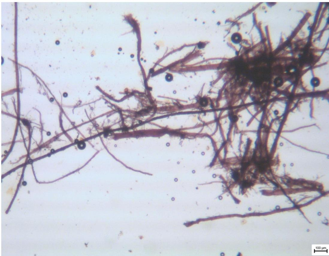
Figura 2. Fibras papeleras de color rojo vinoso, teñidas con colorante de Herzberg, microscopio óptico con luz transmitida.
