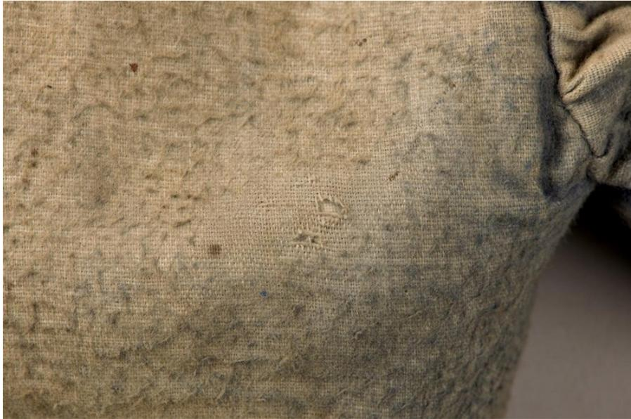
Rotura y desgaste de las fibras del tejido
