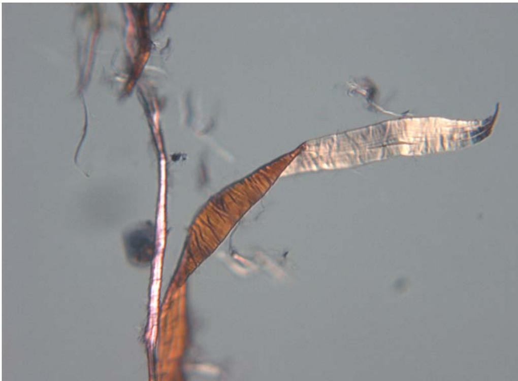
Figura 31. Fibra papeleras de madera, microscopio óptico con luz polarizada, 200X.
