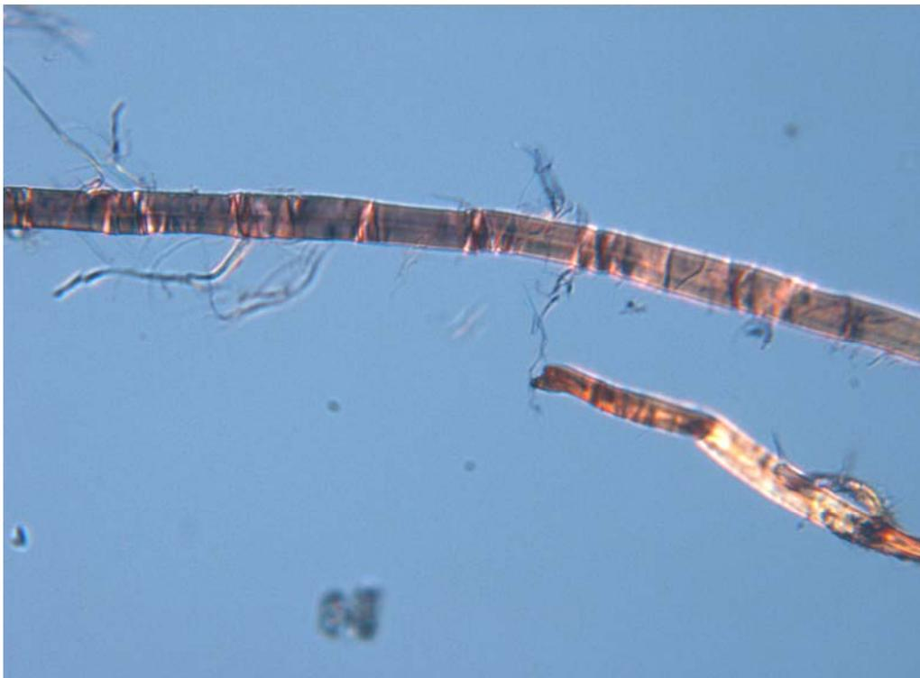
Figura 29. Fibra papelera de cáñamo, microscopio óptico con luz polarizada, 200X.
