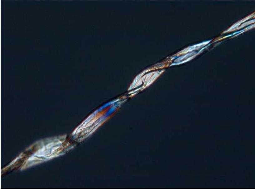
Figura 3. Fibra de algodón del hilo de la costura, microscopio óptico con luz transmitida polarizada, 200X.
