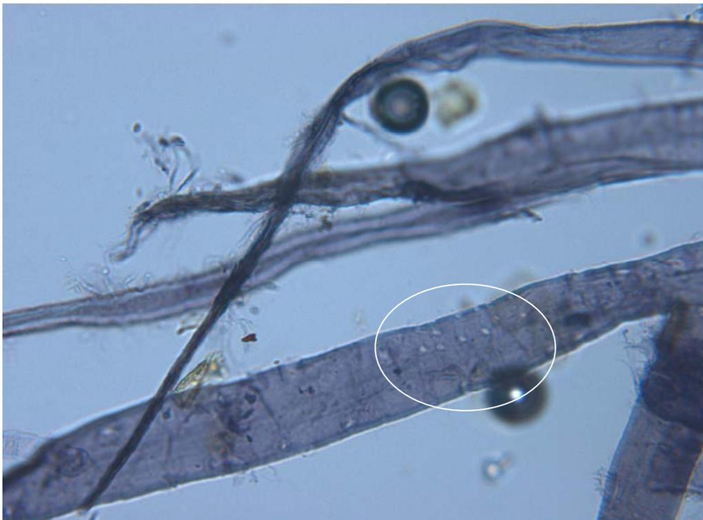
Figura 12. Fibras madereras de conífera, punteaduras de los campos de cruce de tipo piceoide, microscopio óptico con luz normal, 200X.
