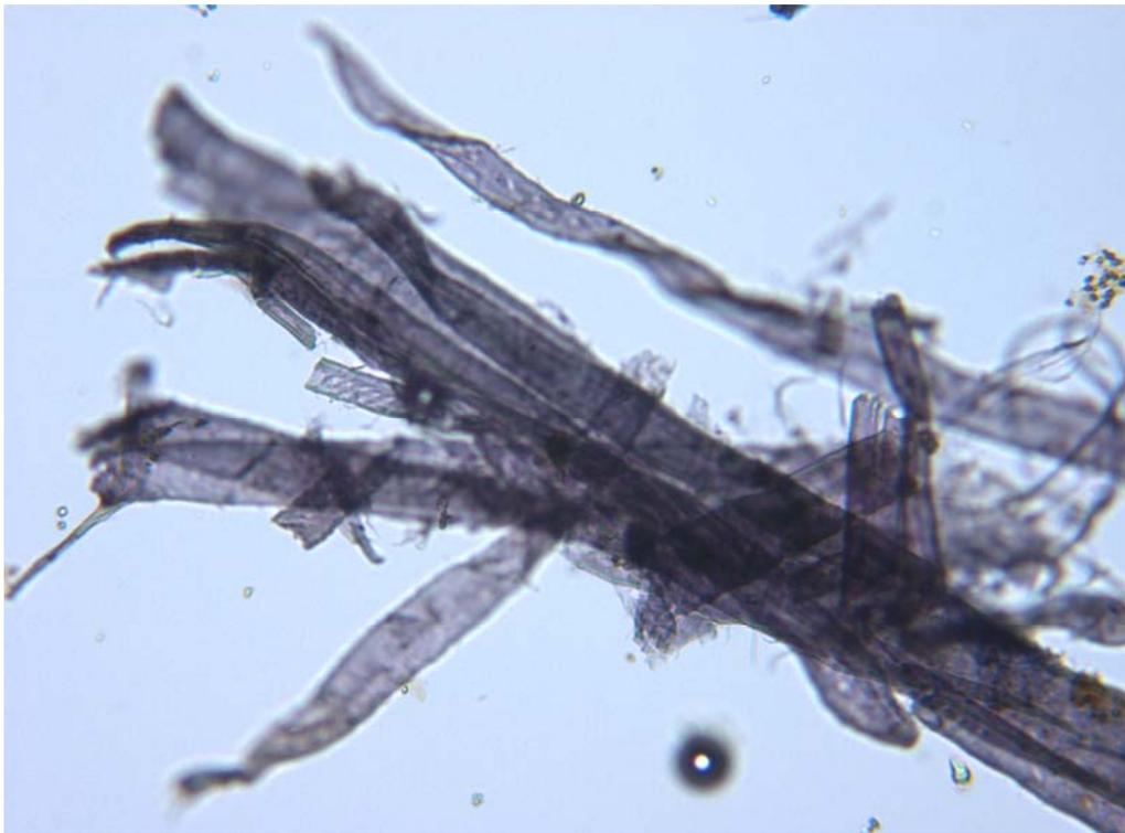
Figura 11. Fibras madereras de conífera, microscopio óptico con luz normal, 100X.
