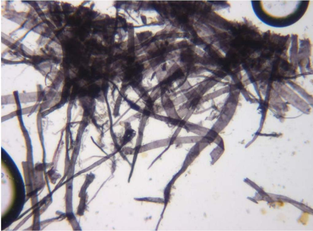
Figura 5. Fibras papeleras de color gris-azulado, teñidas con colorante de Herzberg, 50X.
