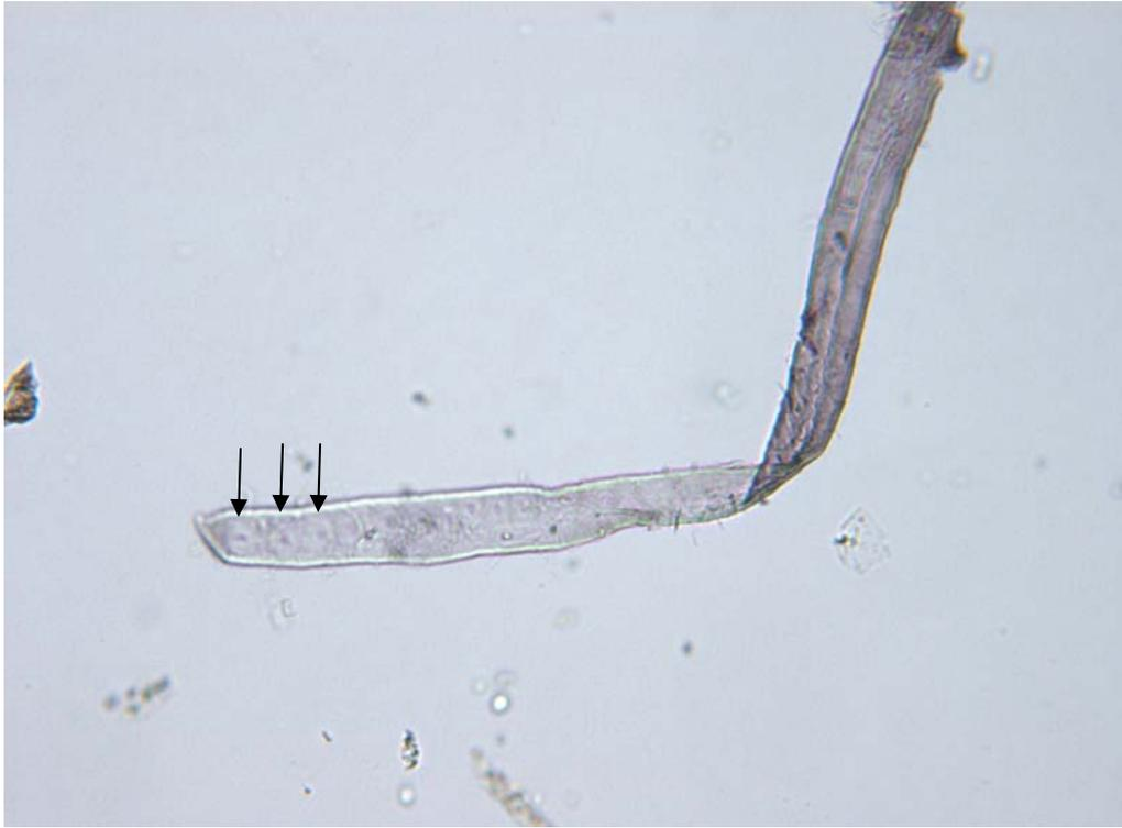
Figura 13. Fibra maderera de conífera, punteaduras areoladas, microscopio óptico con luz normal, 100X.
