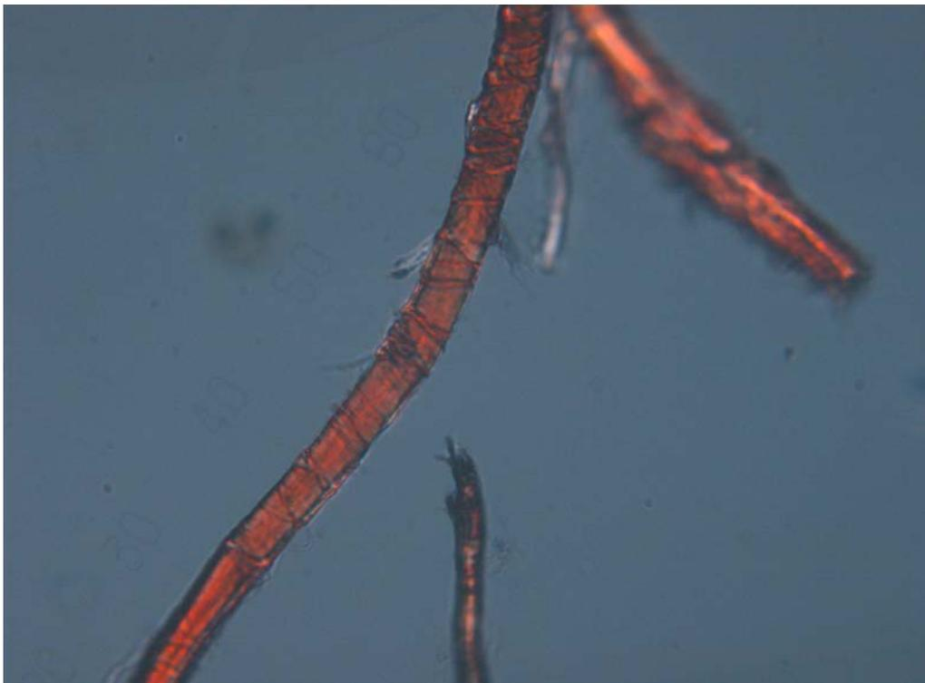
Figura 24. Fibra papelera de lino, microscopio óptico con luz polarizada, 200X.
