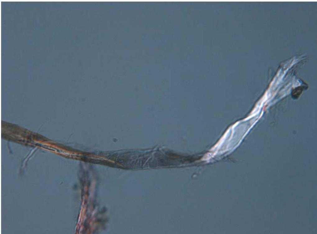
Figura 22. Fibra papelera de algodón, microscopio óptico con luz polarizada, 200X.
