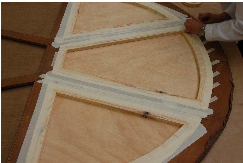
**Figura II. 21.** Colocación de paneles para fijación de estratos.
