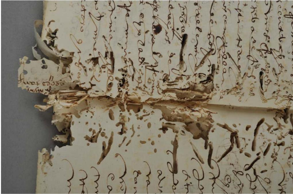
**Figura 9- Alteración o pérdida de material causada por insectos: orificios, galerías.**
