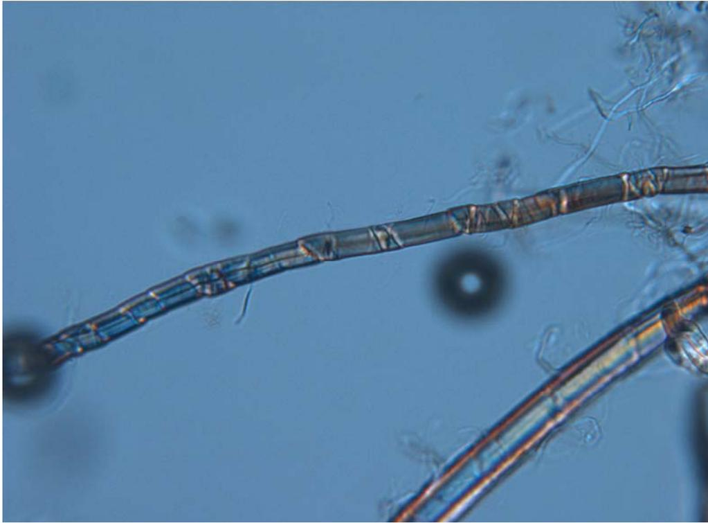
**Figura 6. Fibras papeleras de lino, microscopio óptico con luz polarizada, 200X.**
