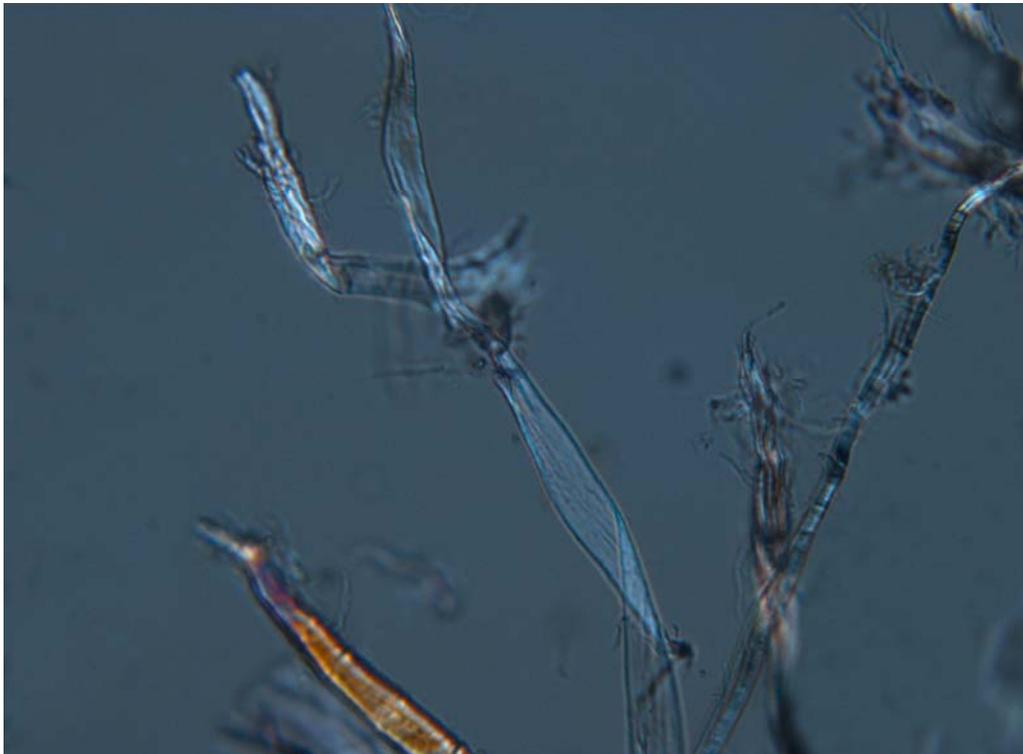
**Figura 7. Fibras papeleras de algodón, microscopio óptico con luz polarizada, 200X.**
