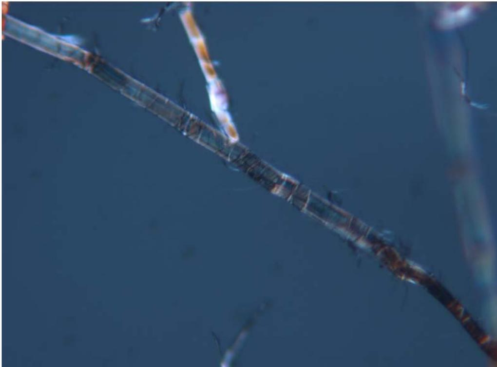
**Figura 5. Fibras papeleras de lino, microscopio óptico con luz polarizada, 100X.**
