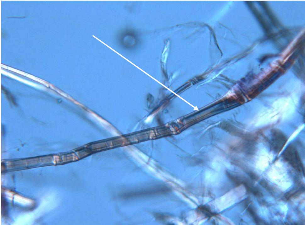
Fibras papeleras de lino, microscopio óptico con luz polarizada, 200X.
