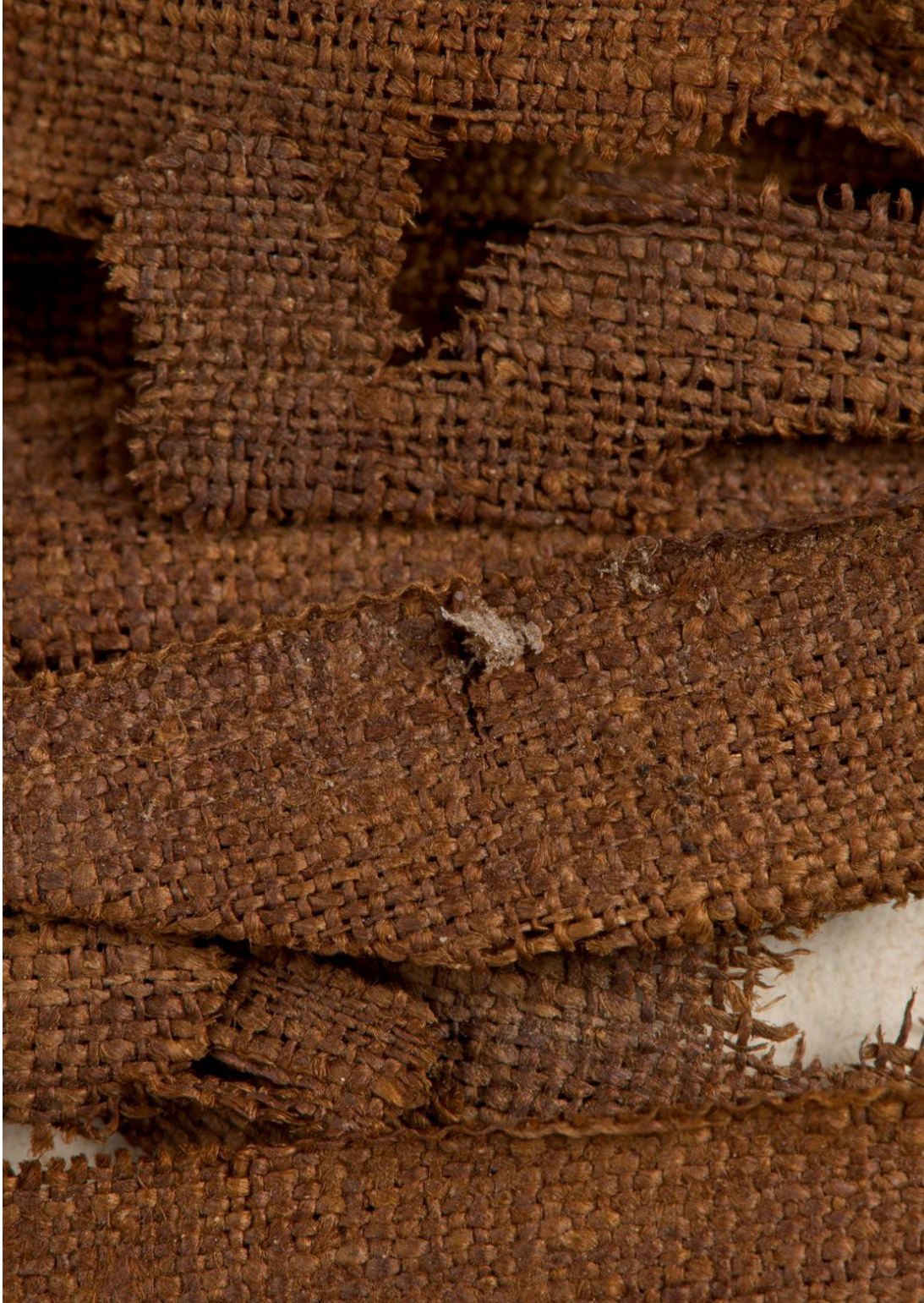
ALTERACIONES. Depósitos de diversa procedencia.
