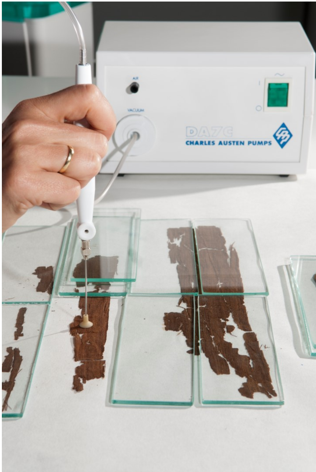
TRATAMIENTO. Aspirado empleando pinza aspiradora con vacío controlado.
