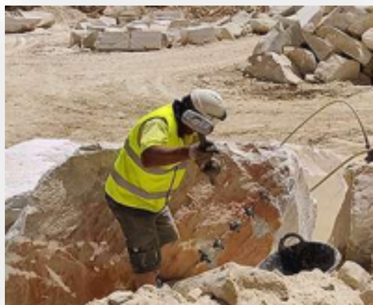
Ilustración 3: Cantero "zoblando" con pinchotes
