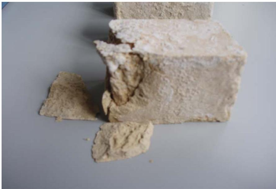
**Fig. 15.** Silo 111. Detalle pérdida capa tratada. Desplacados.
