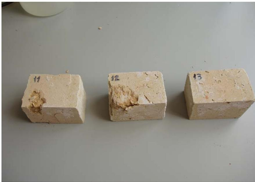
**Fig. 17.** Probetas Protector SX-12. Final del ensayo. 7 ciclos.
