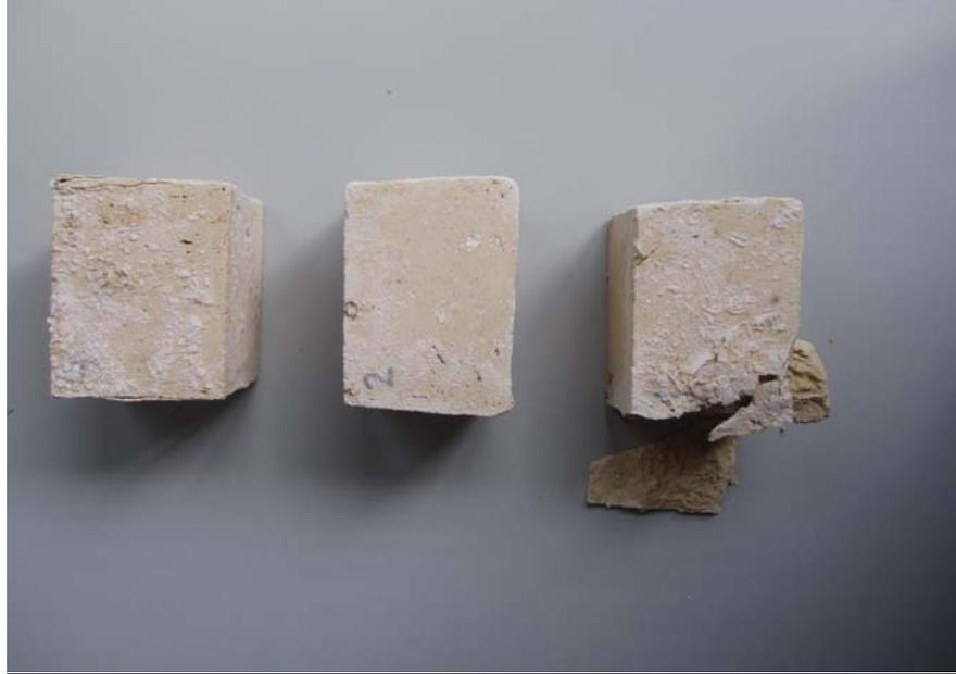
**Fig. 14.** Probetas tratadas con Silo 111. Final ensayo. Desconchaduras
