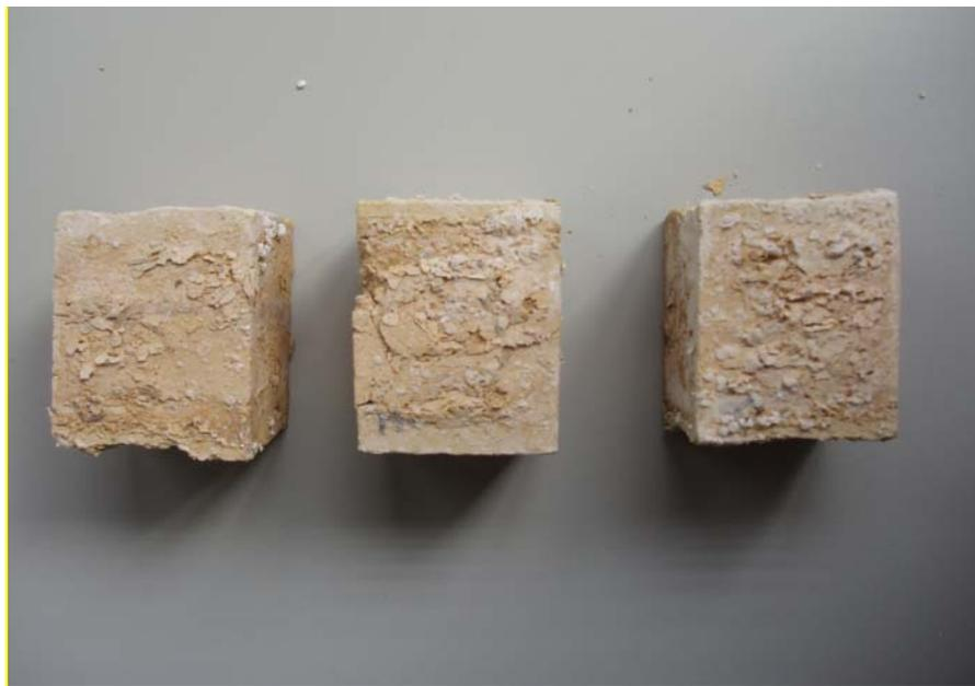
**Fig. 13.** Probetas tratadas con ACRISIL. 5 ciclos. Desconchaduras
