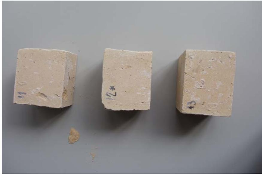
**Fig. 16.** Probetas Protector SX-12. 5 ciclos. Pequeñas desconchaduras
