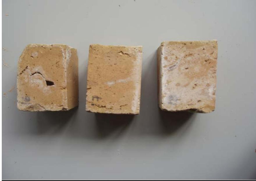
**Fig.12.** Probetas sin Tratar al final del ensayo. Solo eflorescencias
