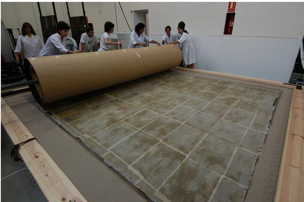
**Fig. II. 32. Proceso de entelado.**
