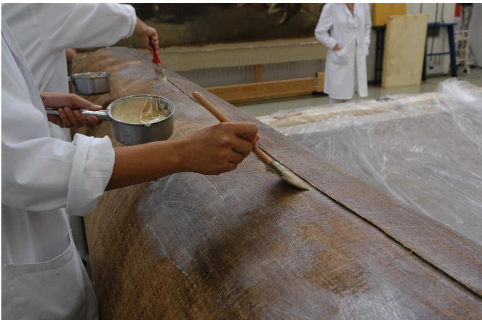
**Fig. II. 30. Proceso de entelado.**
