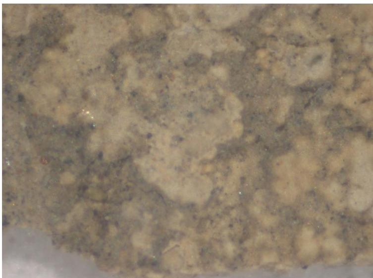
Figura 1. Fotografía con microscopio estereoscópico de la capa de alteración desprendida del vidrio.
