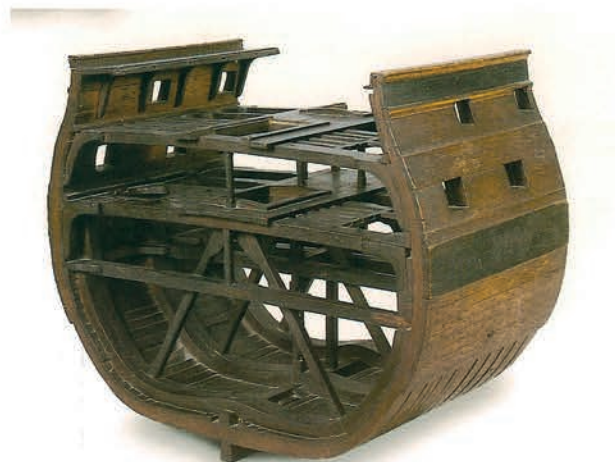
Sección de un navío de línea (sistema Jorge Juan).
