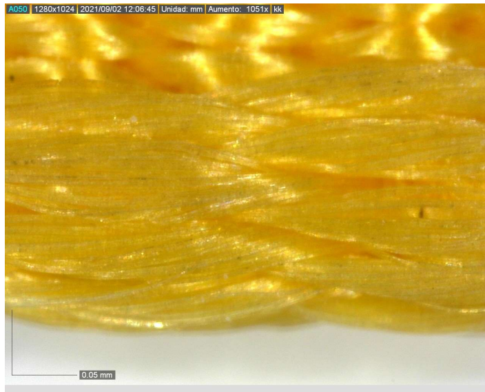
Orillo con ligamento Acanalado de 3 pasadas
