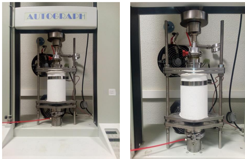
Figura 3.10. Sistema de hotpressing diseñado y montado en el laboratorio durante el desarrollo de esta tesis doctoral.
