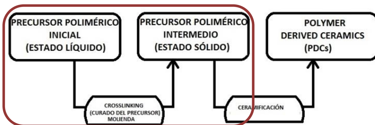
Figura 4.1. Esquema general en el proceso de obtención de una cerámica avanzada (PDC).
