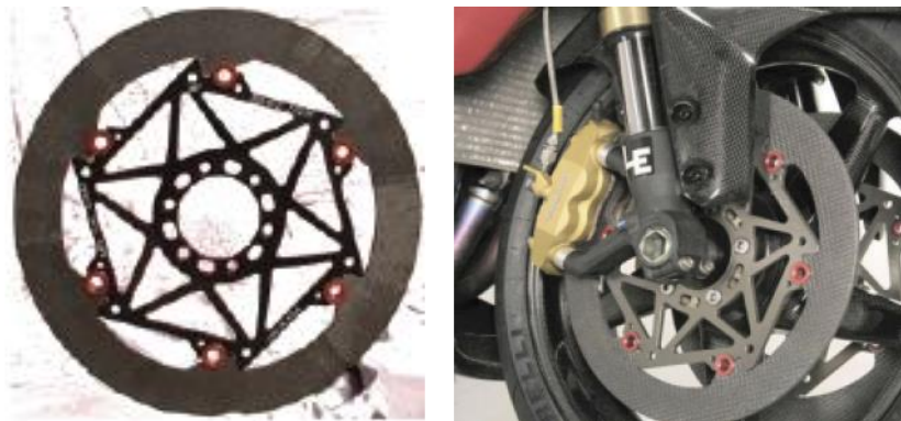
Figura 1.10. Discos de frenos cerámicos de tipo SiC/C/C desarrollados por STARBLADE™ Starfire System Inc.
