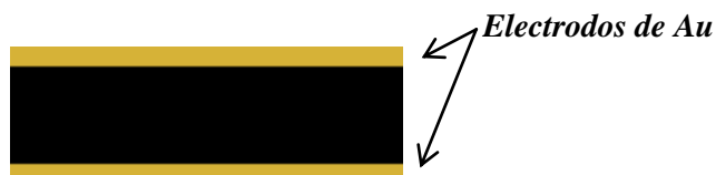
Figura 3.21. Pastillas cerámicas con la disposición de oro en ambas caras (electrodos).
