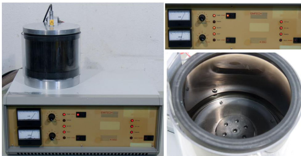
Figura 3.21. Sputter de oro TELSTAR EMITECH K550 utilizado para la deposición del mismo en ambas caras de las pastillas sinterizadas.
