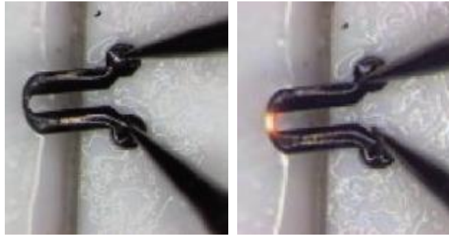
Figura 1.8. Ejemplo de microcalefactor cerámico obtenidos a partir de PDCs de tipo SiCNO (Rishi Raj, University of Colorado, Boulder, USA). 160
