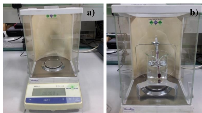
Figura 3.16. a) Balanza analítica de precisión Mettler Toledo modelo AB204-S con b) kit de medida de densidad por Arquímedes.
