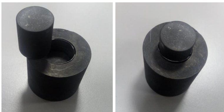
Figura 3.11. Moldes de grafito ( \phi = 10\text{ mm} ) usados en el proceso de prensado en caliente de los sistemas cerámicos (SiCN y SiCO).
