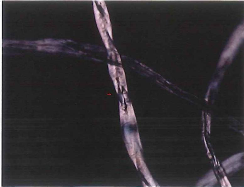
**Fig.13.** Fibras de algodón. Fotomicrografía al microscopio óptico con luz transmitidas de la apariencia longitudinal de las fibras del tejido de las bandas de refuerzos, 200X.
