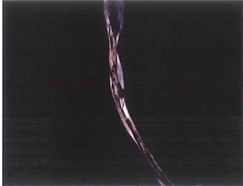
**Fig.19.** Fibras de algodón. Fotomicrografía al microscopio óptico con luz transmitidas de la apariencia longitudinal de las fibras del tejido del parche, 200X.
