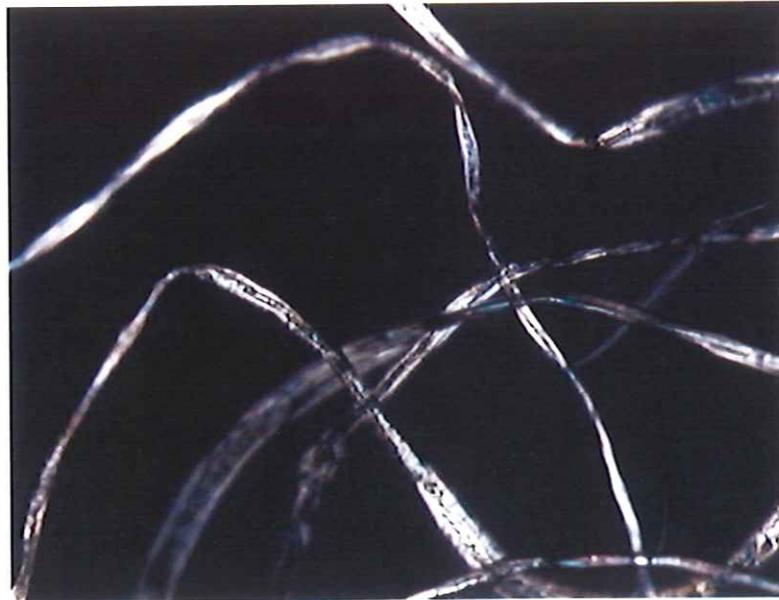
**Fig.10.** Fibras de algodón. Fotomicrografía al microscopio óptico con luz transmitidas de la apariencia longitudinal de las fibras del hilo que cose la franja o reps al las bandas de refuerzo, 200X.
