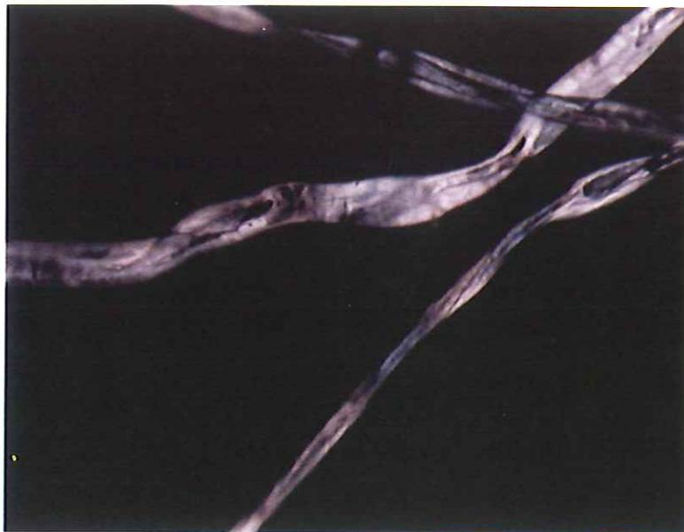
**Fig.24.** Fibras de algodón. Fotomicrografía al microscopio óptico con luz transmitidas de la apariencia longitudinal de las fibras del hilo blanco que sujeta el cordón lateral a la banda de refuerzo, 200X.
