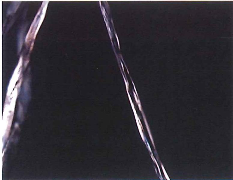
**Fig.12.** Fibras de algodón. Fotomicrografía al microscopio óptico con luz transmitidas de la apariencia longitudinal de las fibras del hilo que cose las bandas de refuerzo al tapiz, 200X.
