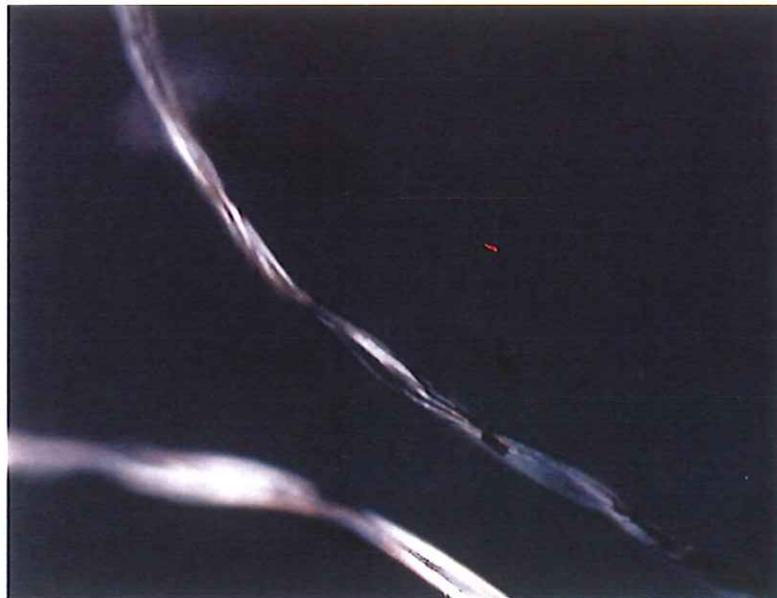
**Fig.20.** Fibras de algodón. Fotomicrografía al microscopio óptico con luz transmitidas de la apariencia longitudinal de las fibras del hilo que cose los cortes verticales o "relais", 200X.
