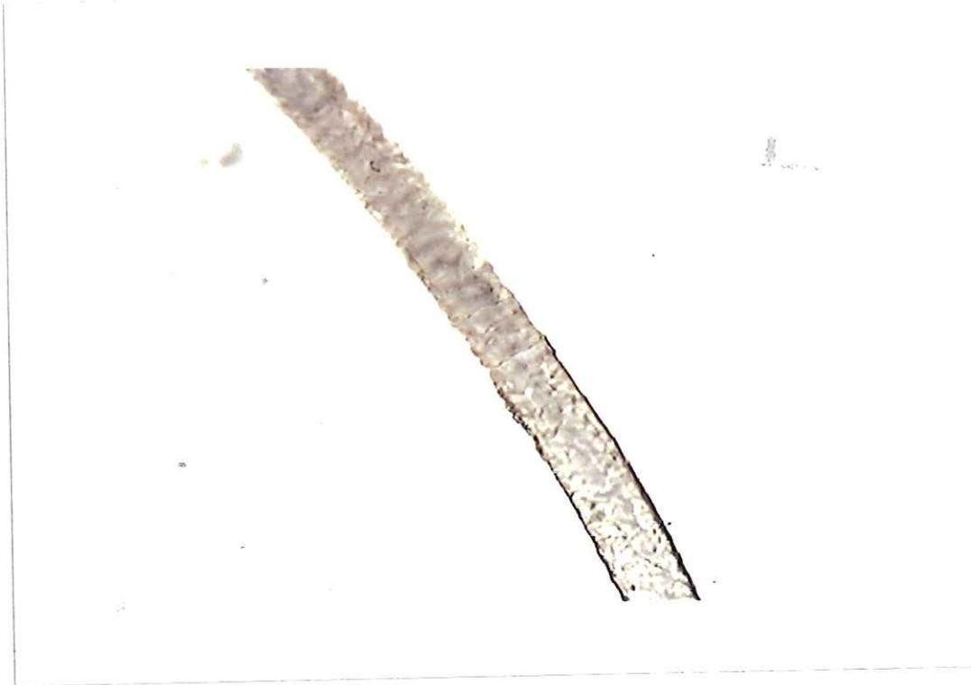
**Fig.1.** Fibras de lana. Fotomicrografía al microscopio óptico con luz transmitidas de la apariencia longitudinal de la urdimbre original del borde de laguna retejada, 200X.
