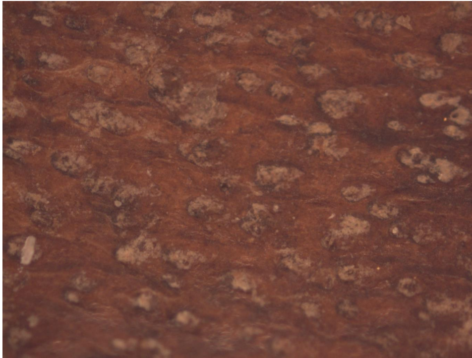
Superficie flor de la muestra al microscopio óptico con luz reflejada, a 50X.
