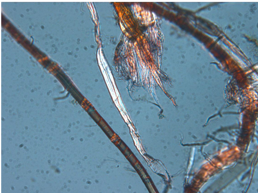
Figura 5. Fibras papeleras de cáñamo y/o lino y algodón, microscopio óptico con luz polarizada, 200X.
