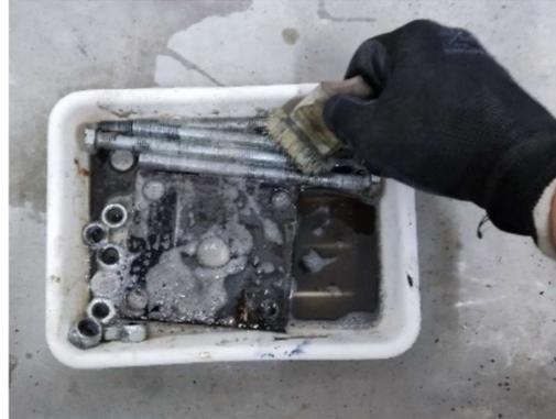
*Tratamiento. Interior del cajón. Desmontaje y limpieza de las pletinas y pernos fijadores de las ballestas de suspensión.*
