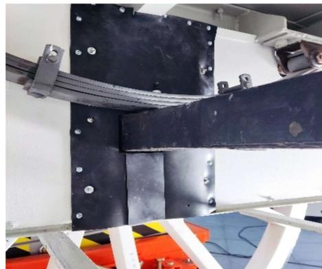
*Tratamiento. Interior del cajón. Cerramiento de los pasos de ruedas. Se fijó con tornillería una plancha de goma de 3mm., ajustada al contorno del eje de las ruedas, a fin de minimizar la entrada de arena y suciedad por estos huecos.*
