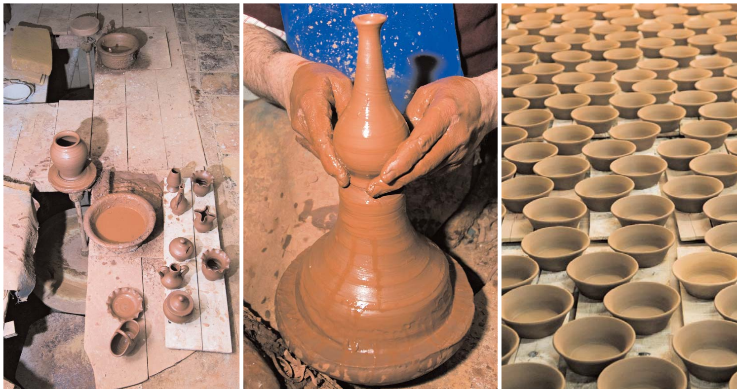
📍 Alfarería Los Puntas en Albox. Torno tradicional hundido para el modelado; proceso de modelado y levantado; y secado de piezas / FOTO: JUAN CARLOS CAZALLA, IAPH
