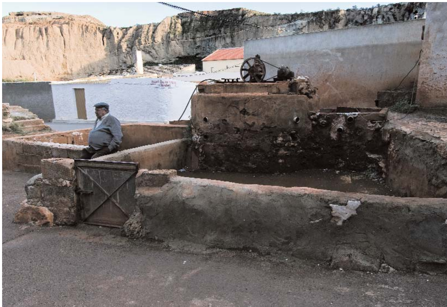
❶ Sistema de pilas y balsa adosada empleados en el proceso de elaboración del barro. Alfarería Hijos de Juan Simón. Sorbas / FOTO: JUAN CARLOS CAZALLA, IAPH
