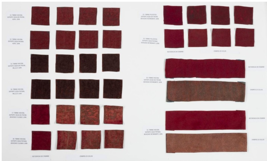
Figura 3.- Probetas de viscosa con distintos adhesivos y soportes de seda estudiados.
