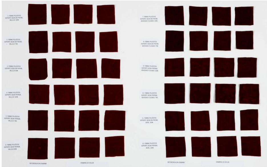
Figura 2.- Probetas de poliéster estudiadas con distintos adhesivos y soportes de seda.
