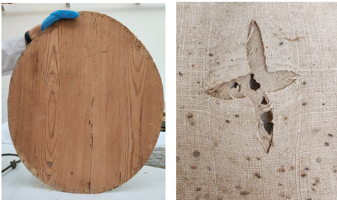
Daños causados por insectos en la madera del óvalo central y en el tejido y papel subyacentes.
