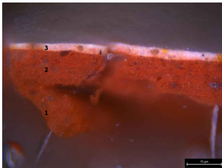
Figura 7. Imagen obtenida al microscopio óptico de la sección transversal de la micromuestra analizada GALL-3 con luz reflejada (objetivo MPlan 20X/0,45).
