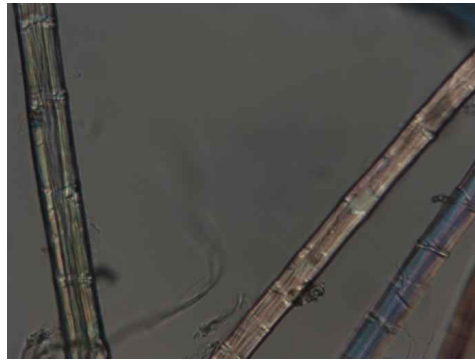
Figura 22. Fibras GALLF-2, Microscopio óptico con luz transmitida (polarizador, 20X)
